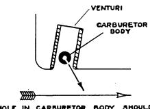
HOLE IN CARBURETOR BODY SHOULD BE POINTED DOWN AND TOWARD FRONT OF ENGINE AS SHOWN
